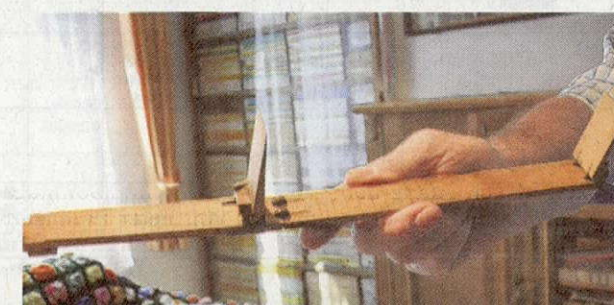
Spezialmaß für Schuhmacher: Mit diesem Meterstab kann ein Fuß vermessen und ohne weitere Rechenoperationen der entsprechenden Schuhgröße zugeordnet werden.
