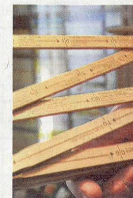
Dieser Meterstab hat keine Meter, sondern zeigt dem Gärtner den richtigen Pflanzabstand für Kresse, Feldsalat, Erdbeeren und Co.
